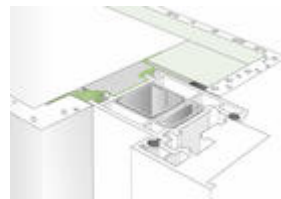
Bild 6: Befestigung der Folie innen wie Außenseite
