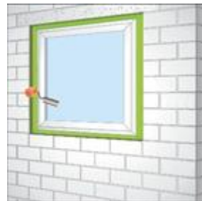
Bild 8: Folie mit Andruckroller anrollen
