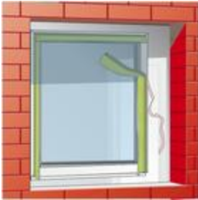
Bild 1: TP601 mit der Selbstklebung am Fensterrahmen fixieren.
