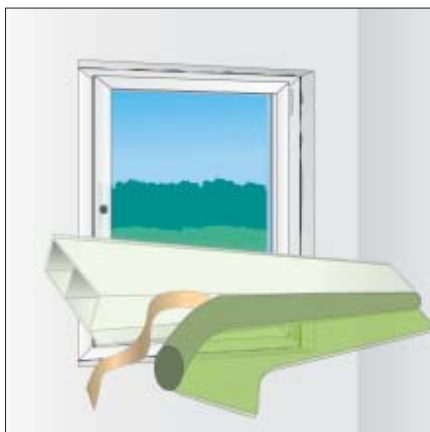
Bild 3: Befestigung der Selbstklebung von illmod i an der Kammerleiste.
