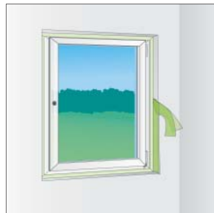
Bild 4: Nach Befestigung der Kammerleiste am Rahmen Aktivierung von illmod i durch Abtrennung der überstehenden Folie.
