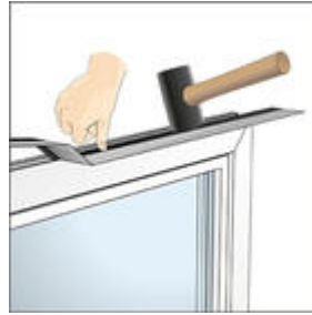
Bild 6: Geeignete Kederfolie in die äußeren Blendrahmen-Nuten einbringen
