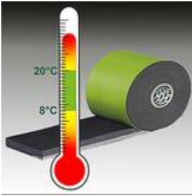
Bild 5: Lagerung und Verarbeitung von TP652 zwischen 8°C - 20°C. Hohe Temperaturen beschleunigen das Aufgehverhalten, tiefe verzögern es (siehe Vorbereitung).
